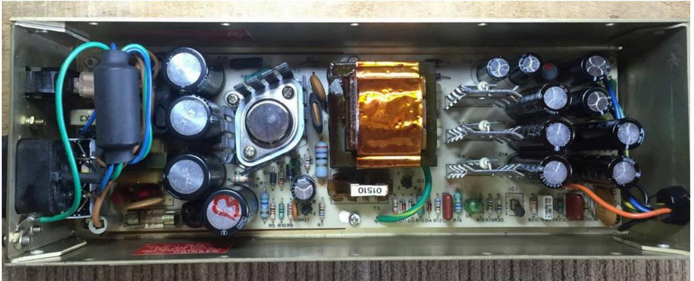
Avant de remonter l'alimentation dans l'Apple IIe, je vérifie les tensions d'alimentation au multimètre. Pas besoin de consulter le manuel, les tensions sont indiquées sur le bloc alimentation. Encore un truc bien pensé.
