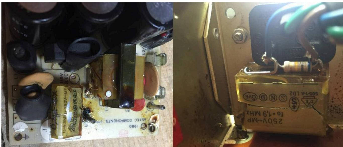
Il s'agit de **condensateurs de filtrage**, composants électroniques antiparasites qui permettent de lisser la tension. C'est assez facile de les remplacer grâce à Internet. Il suffit de taper la référence du composant, et on trouve souvent du stock, neuf ou d'occasion, sans parler des documentations et des plans.
