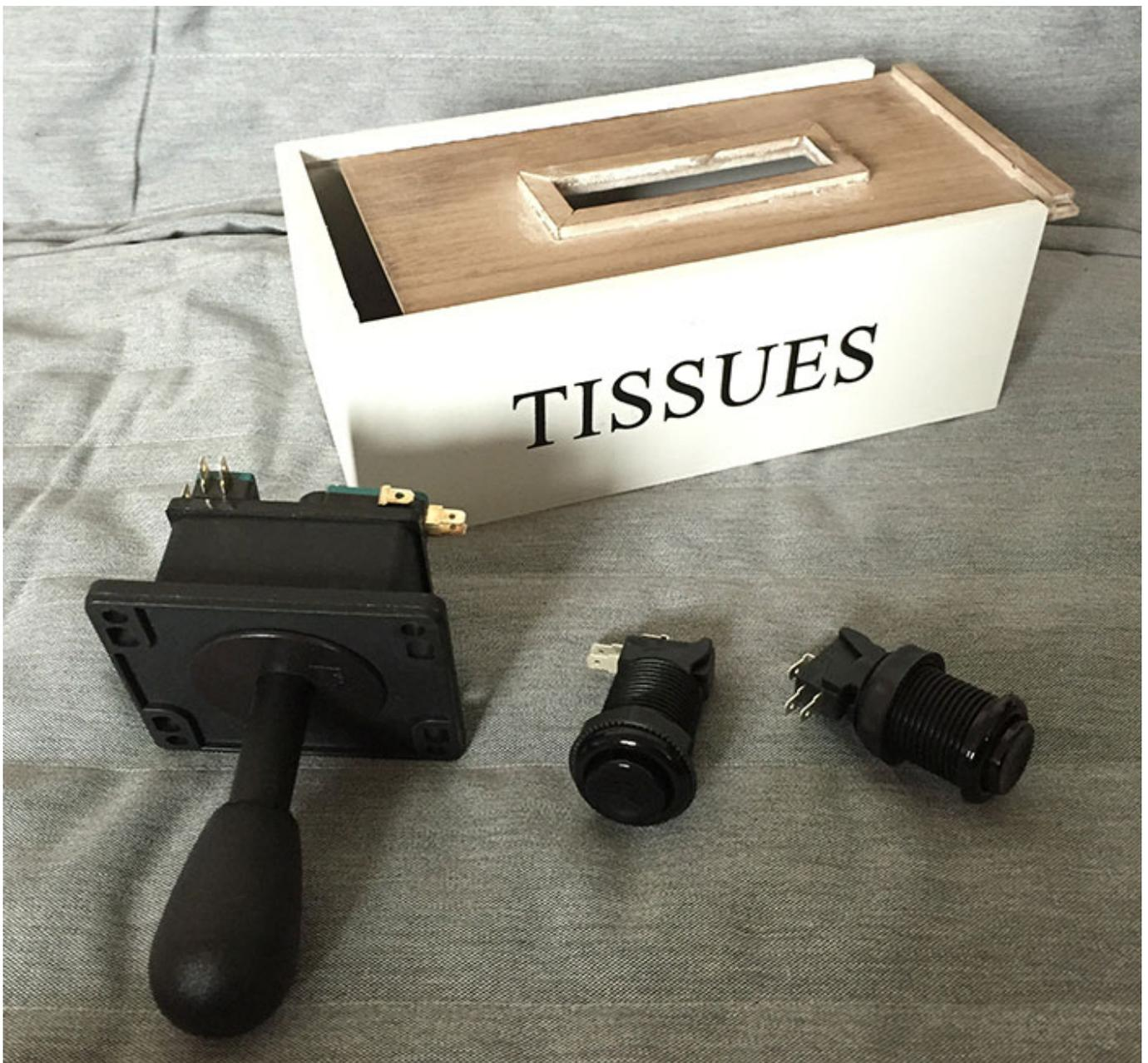
Il faudra que je découpe un peu la boîte pour réduire sa hauteur. Je calcule ça en fonction de la profondeur du joystick. Pour la découper, j'ai utilisé une scie sauteuse, une lime et perceuse.
