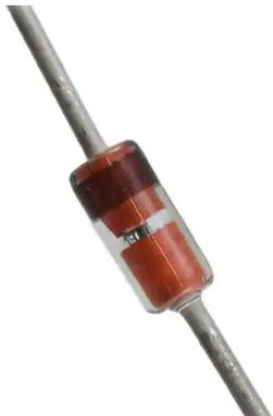
La diode 1N914 permet d'envoyer les signaux de synchronisation sur la sortie composite. Dans une diode, le courant ne circule que dans un sens ce qui empêche les signaux vidéos d'être envoyés vers le processeur GI.
