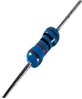
La résistance 750 ohms contrôle la luminosité de l'image. La luminosité augmente en diminuant la valeur de la résistance. On pourrait remplacer cette résistance par une résistance variable afin d'ajuster la luminosité à sa convenance.
